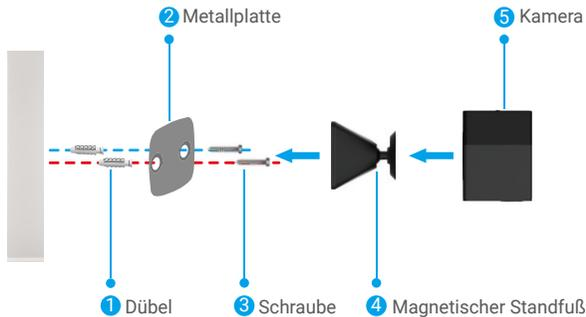
Abb. 2 Montage mit Schrauben
