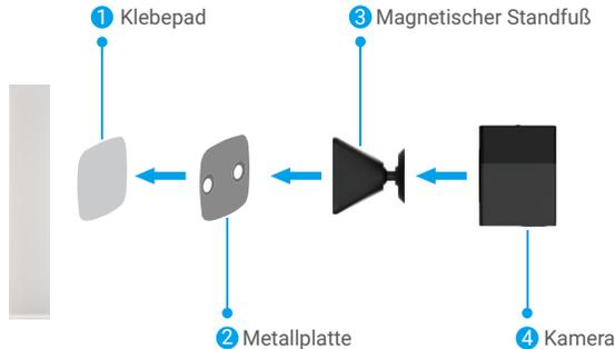
Abb.1 Montage mit dem Schaumstoff-Aufkleber
